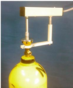
Баллон с установленным пневматическим храповиком
